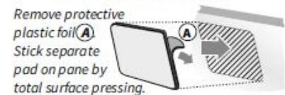
**3** Schutzfolie B von Klebe-Pad abziehen.
